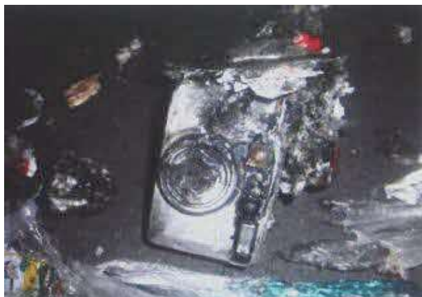
発火原因となったデジタルカメラ (リチウムイオン電池内蔵)
