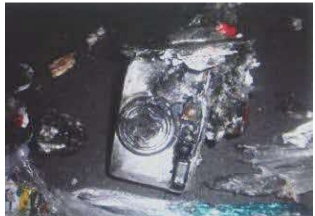
発火原因となったデジタルカメラ (リチウムイオン電池内蔵)
