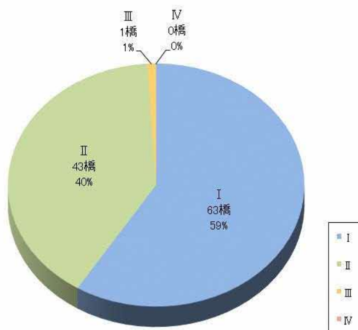
図4 健全性の診断状況
